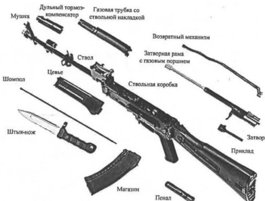
Б) Для чего предназначена часть, отсутствующая на рисунке?
